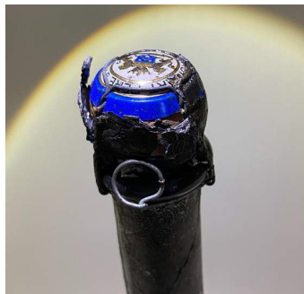
Cierre deformado y falta parte de la lámina
